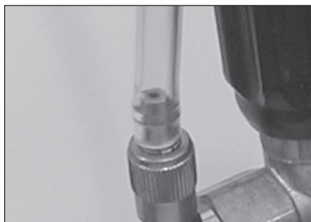
Figura 2 - Conecte el tubo de succión al conector dentado
