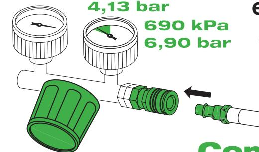
**Conecte** la manguera de aire a la salida del regulador. **Ajuste** la perilla reguladora para que la presión de salida sea de entre 4,14 bar y 6,90 bar (60 psi y 100 psi).
