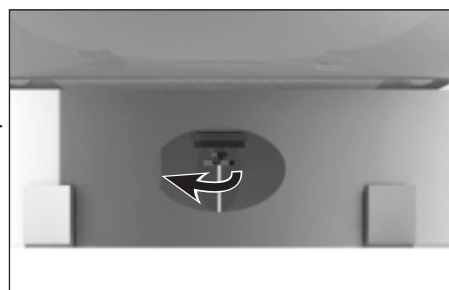
Figure 10 - Drain manuel du réservoir
