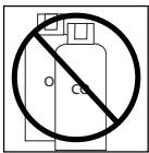
Use sólo aire comprimido filtrado, lubricado y regulado. El uso de un gas reactivo en vez de aire comprimido puede provocar que la herramienta explote, lo cual puede ocasionar la muerte o graves lesiones personales.
