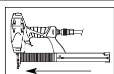
5. Toujours retirer toutes les attaches du chargeur avant de ranger l'outil. Le déchargement est l'inverse du chargement, sauf qu'on doit débrancher l'approvisionnement d'air avant de décharger.
