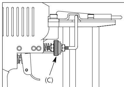
3. Pour enfacer une attache plus profondément, tourner la roue (C) vers la gauche jusqu'à la profondeur recherchée.
