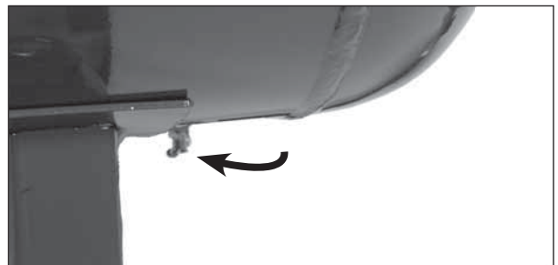
Figure 12 - Drenaje manual del tanque
