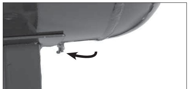
Figure 12 - Drain de réservoir manuel
