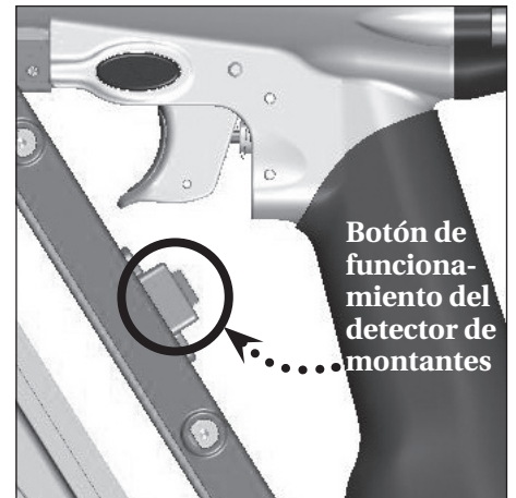
Figura 22- Botón de funcionamiento del detector de montantes
