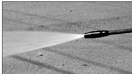
Figura 14 - Patrón de abanico amplio
