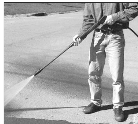
Figura 15 - Mejor ángulo de limpieza de superficies
