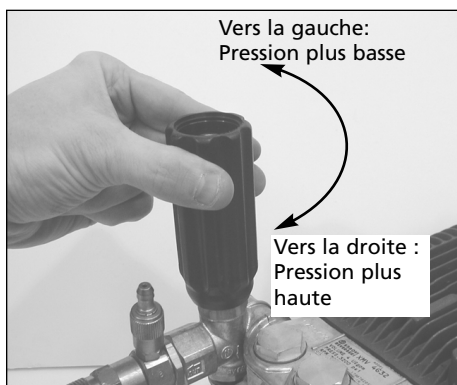
Figure 10 - Ajustement de pression de la pompe à cames
