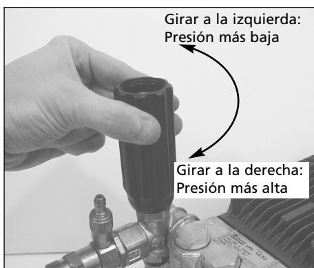
Figura 10 - Ajuste de la presión de la bomba de árbol de distribución
