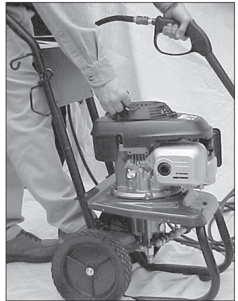
Figure 16 - Démarrage du moteur
