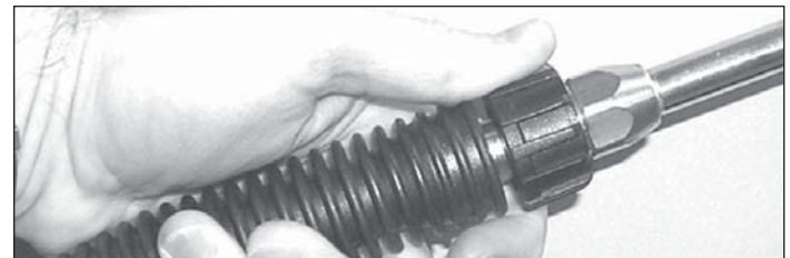
Figura 9 - Conecte la lanza a la pistola
