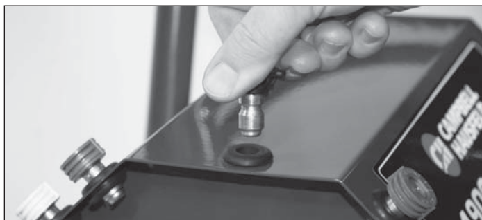
Figura 6 - Inserte las boquillas rociadoras en el porta boquillas
