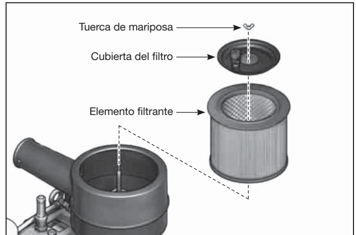
Figura 14 - Filtro de la admisión del aire
