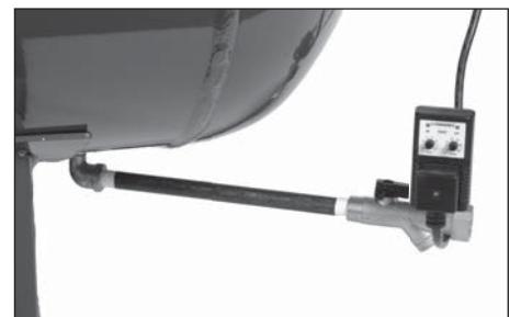
Figura 11 - Drenaje automático del tanque
