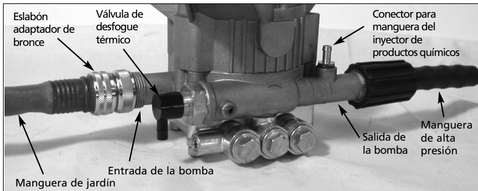
Figura 2 - Conexión de la bomba
