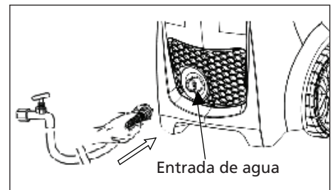
Figura 14 - Conecte la manguera de jardín a la unidad (modelos PW1625 y PW1835)
