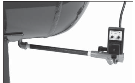
Figura 10 - Drenaje automático del tanque
