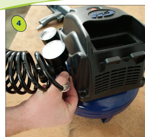
Attachez le boyau d'air au compresseur d'air.
