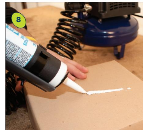
Testez un boudin de mastic en tirant la gâchette et en glissant le boudin sur un morceau de carton. Ajustez la pression d'air, la taille de l'extrémité du tube et la vitesse au besoin. Ne dépasser pas 138 kPa.
