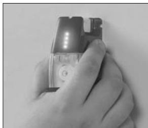
Localisateur de montant – Tenez enfoncé le bouton « Stud finder » (situé sur le côté de l'unité) à mesure que vous placez le LaserFind en position verticale contre le mur.
