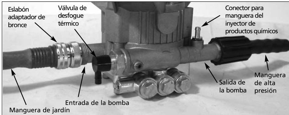
Figura 2 - Conexión de la bomba
