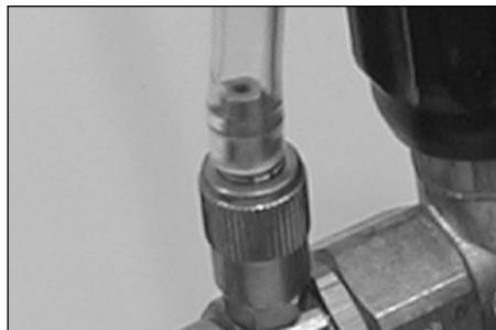
Figura 2 - Conecte el tubo de succión al conector dentado
