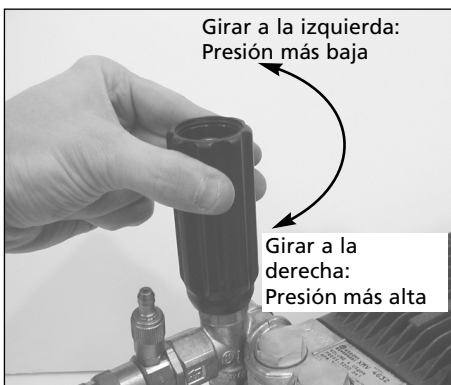
Figura 11 - Ajuste de la presión de la bomba de árbol de distribución
