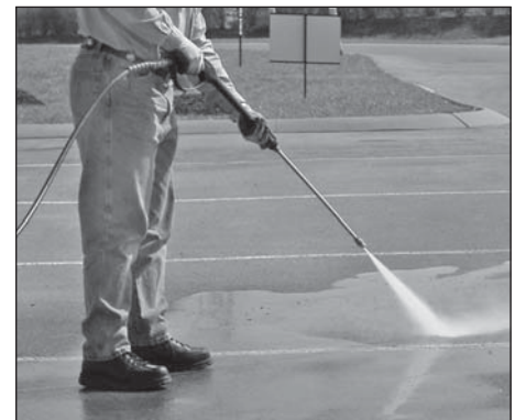
Figure 12 - Angle optimum par rapport à la surface à nettoyer
