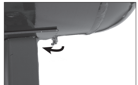
Figure 10 - Drain de réservoir manuel
