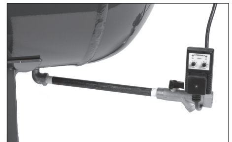
Figura 11 - Drenaje automático del tanque
