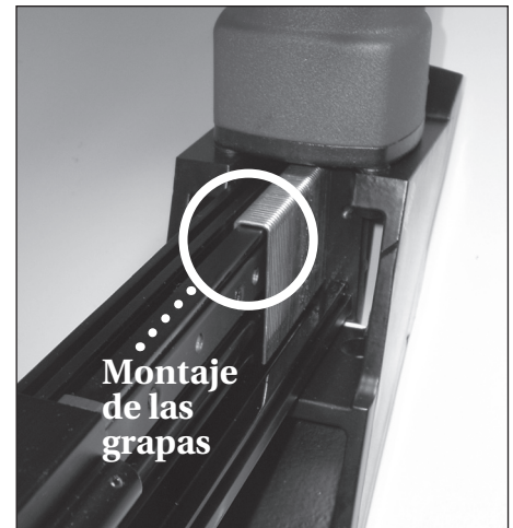
Figura 17 - Coloque las grapas montadas en la parte superior del cargador
