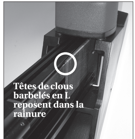
Figure 19 - La tête des clous barbelés en L doit reposer sur la rainure du chargeur fixe
