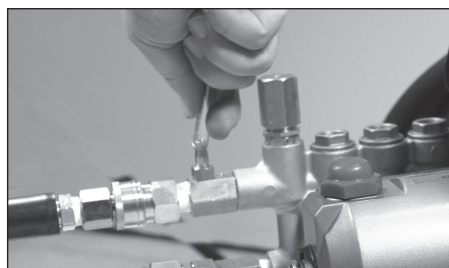
Figure 10 - Fixez le tube d'aspiration à la tête
