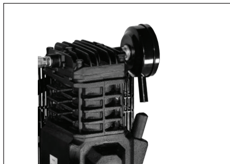
Figura 10 - Filtro de aire
